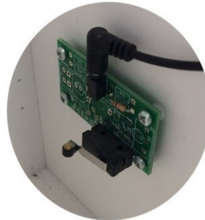
Le micro-rupteur à galet est contacté quand la porte s'ouvre et « appuie sur le galet »
