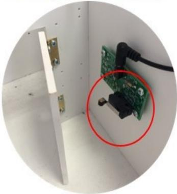
Le microinterrupteur à galet détecte si la porte est **ouverte ou fermée**
